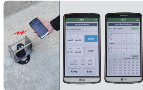
전용 앱에 의한 현장측정 및 데이터
